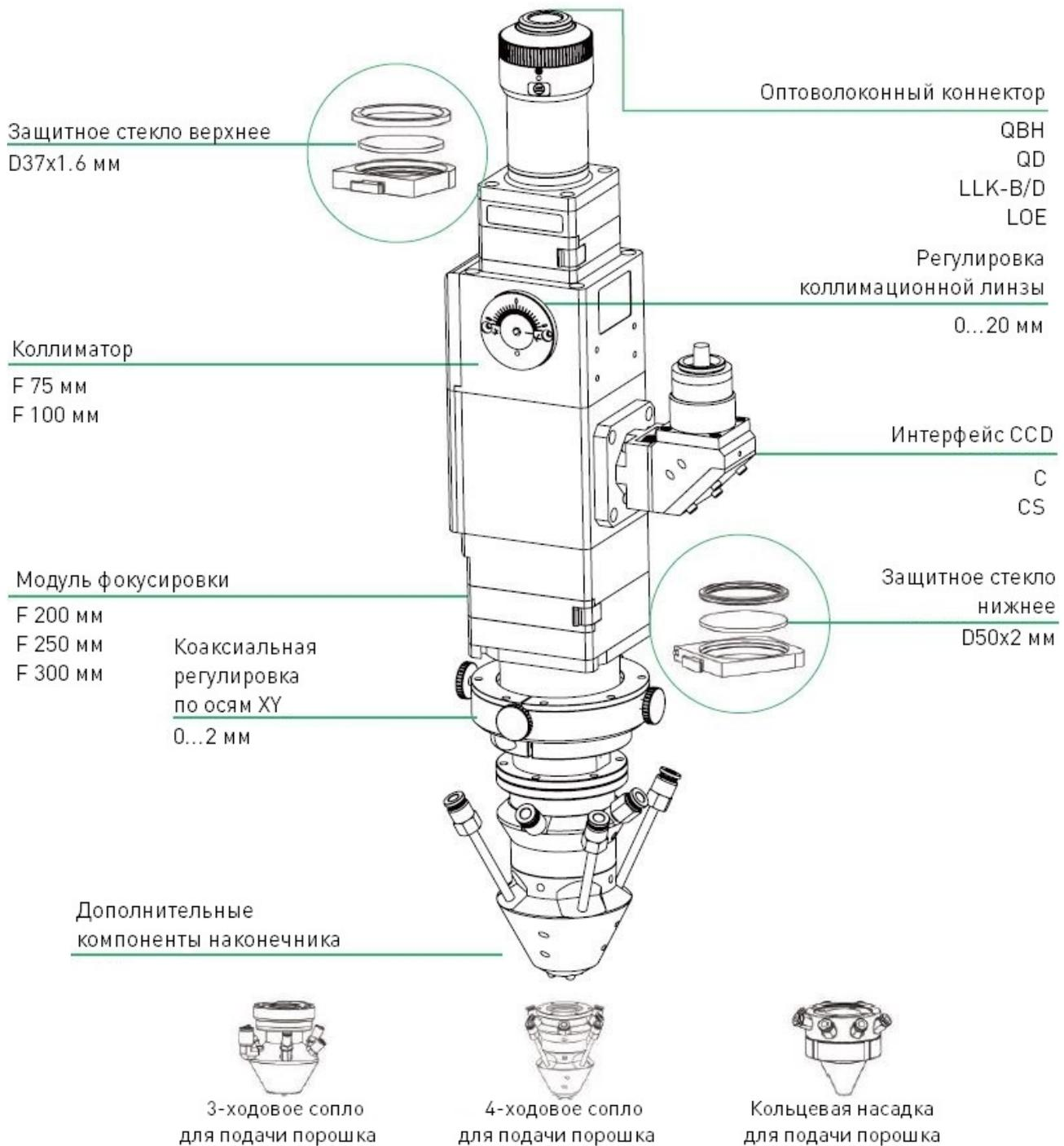
Рисунок 3 — Схематическое изображение лазерной головки для наплавки BC106.
