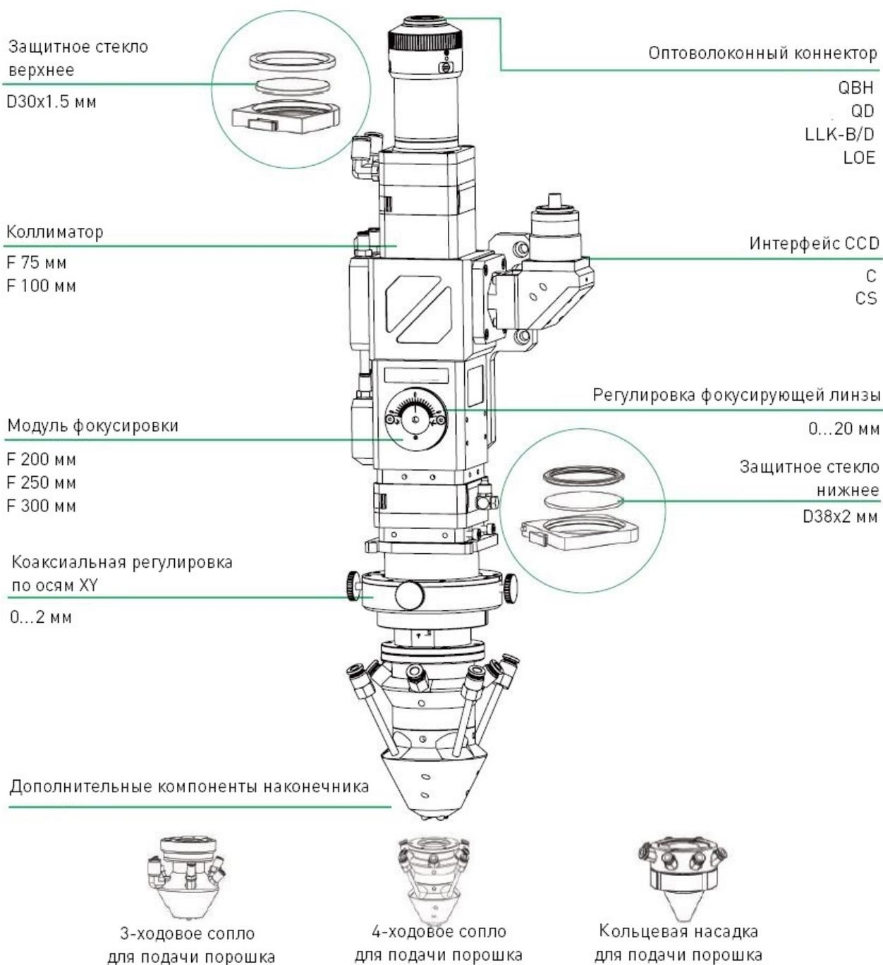
Рисунок 2 — Схематическое изображение лазерной головки для наплавки BC104.
