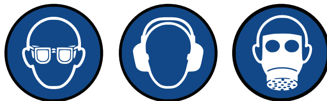
Рис. 2. Работать в защитных очках, наушниках и респираторе
