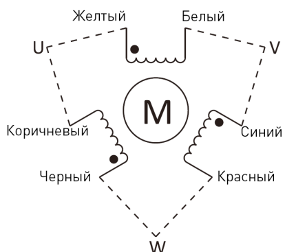
Рис. 7. Цветовая маркировка выводов фаз двигателя
