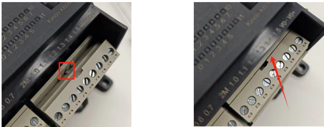
Рисунок 28 – Порядок сборки клеммного блока.
