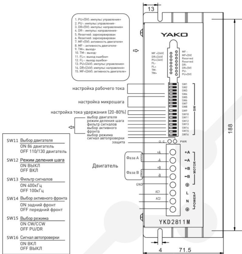
Рис. 2. Подключение драйвера
