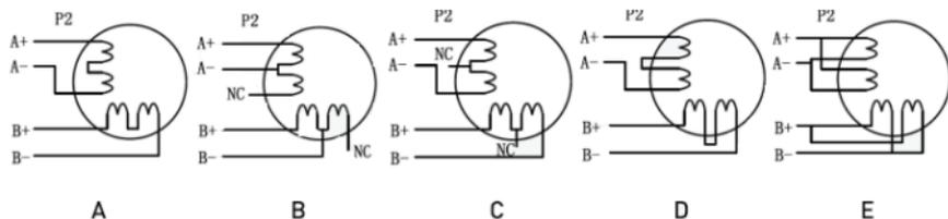
Рис.4. Возможные схемы подключения обмоток шаговых двигателей
