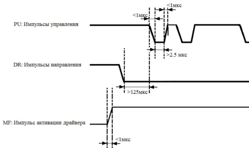
Рис.3 Диаграмма импульсов управления
