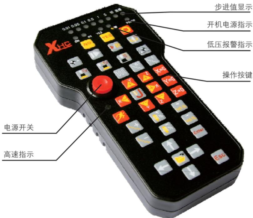
备注：当低压指示灯亮的时候，表示电池电量快用完了，建议更换电池。
