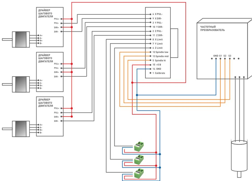
Типичная схема коммутации станка с системой NC Studio v5, вариант 2:
