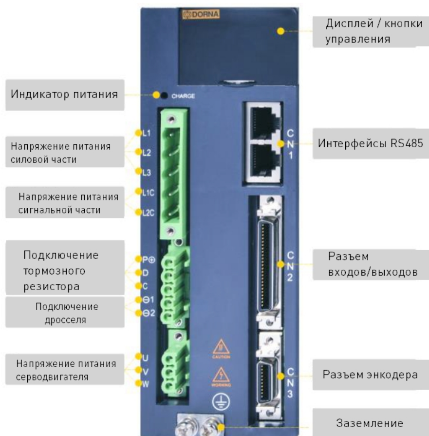
Рис. 6. Разъемы драйвера
