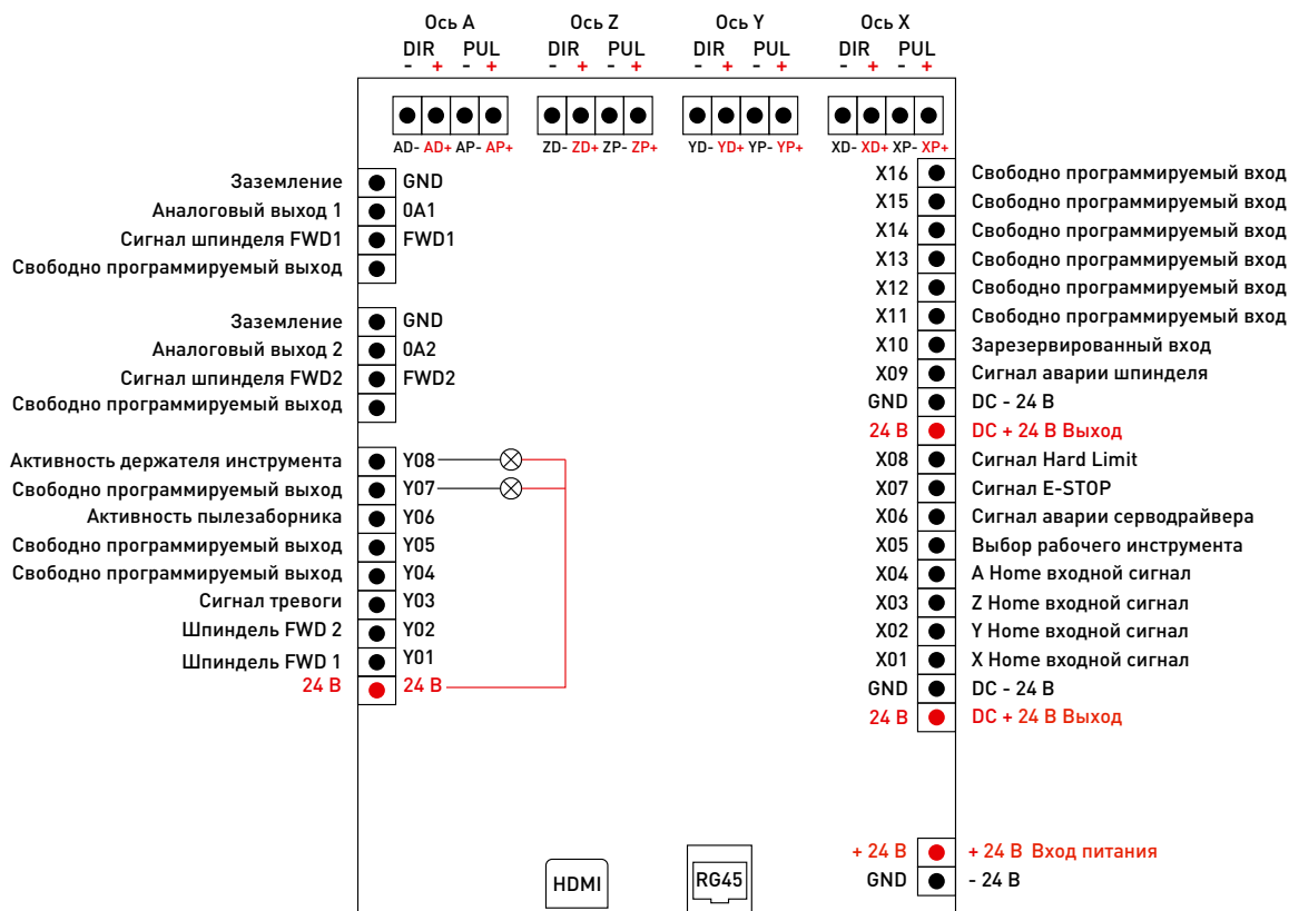
Рисунок 6 — Сигналы платы подключения к шаговому двигателю. Серия B58
