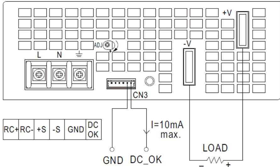
Рис. 6. Подключение сигнала DC\_OK
