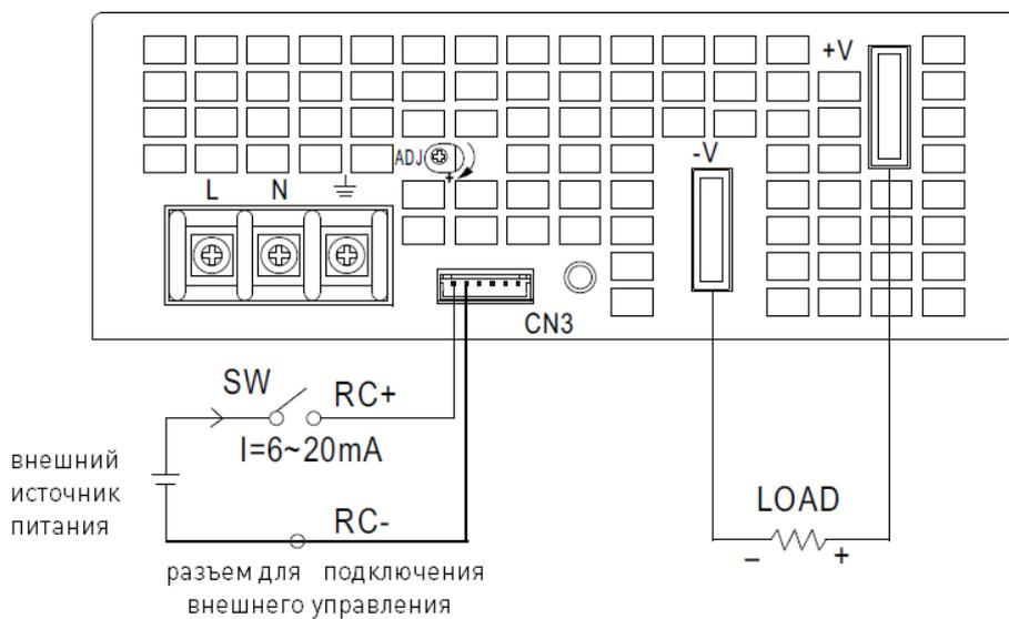
Рис. 7. Подключение внешнего управления
