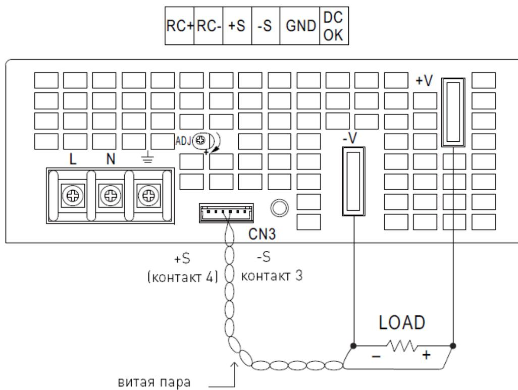
Рис. 8. Подключение внешнего датчика
