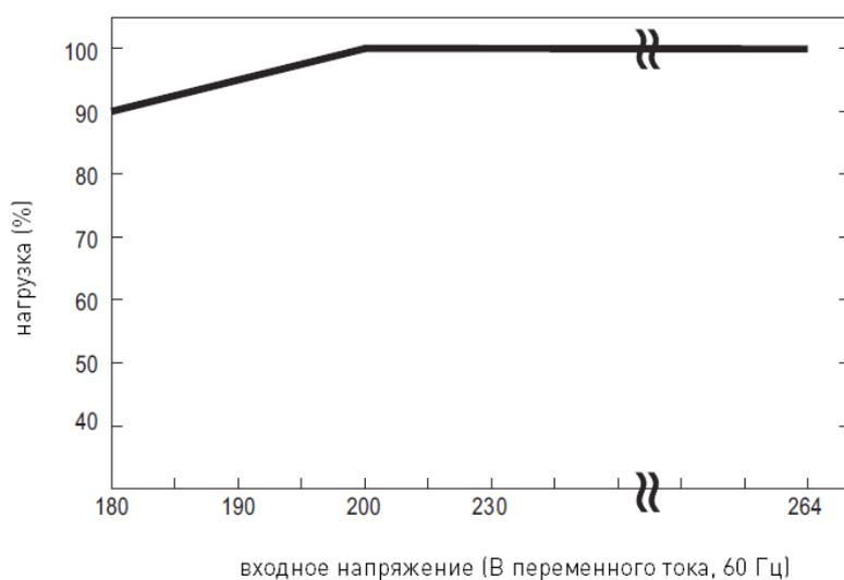
Рис. 5. Зависимость нагрузки от входного напряжения
