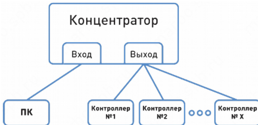
Рис. 37. Настройка подключения к ПК через концентратор
