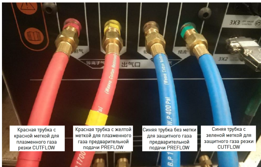
Рисунок 15 — Соединение со стороны газовой консоли.
