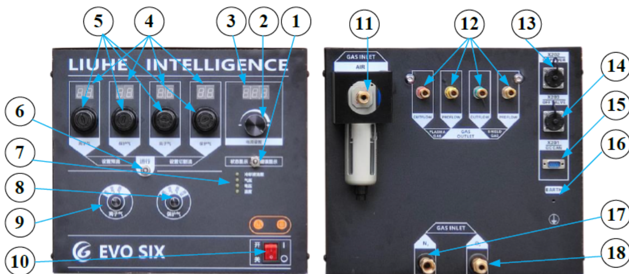
Рисунок 4 — Функциональные элементы передней и задней панелей газовой консоли PMGC-S.
