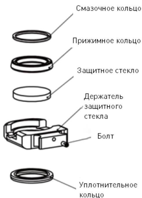
Рисунок 13 – Модуль нижнего защитного стекла.
