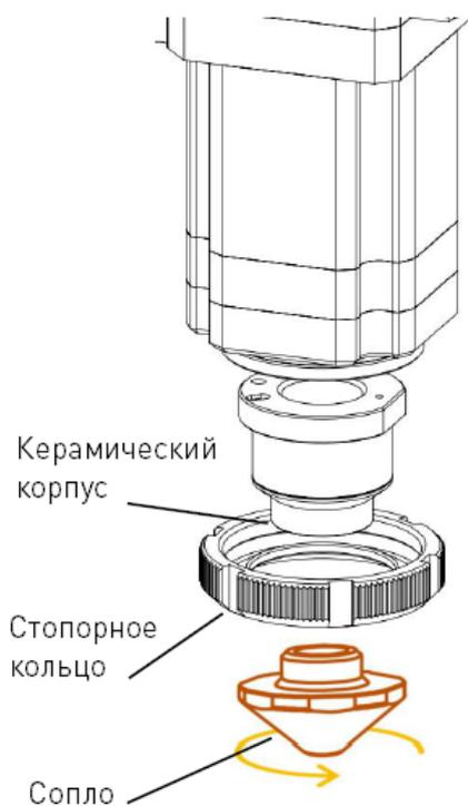
Рисунок 25 – Установка сопла.
