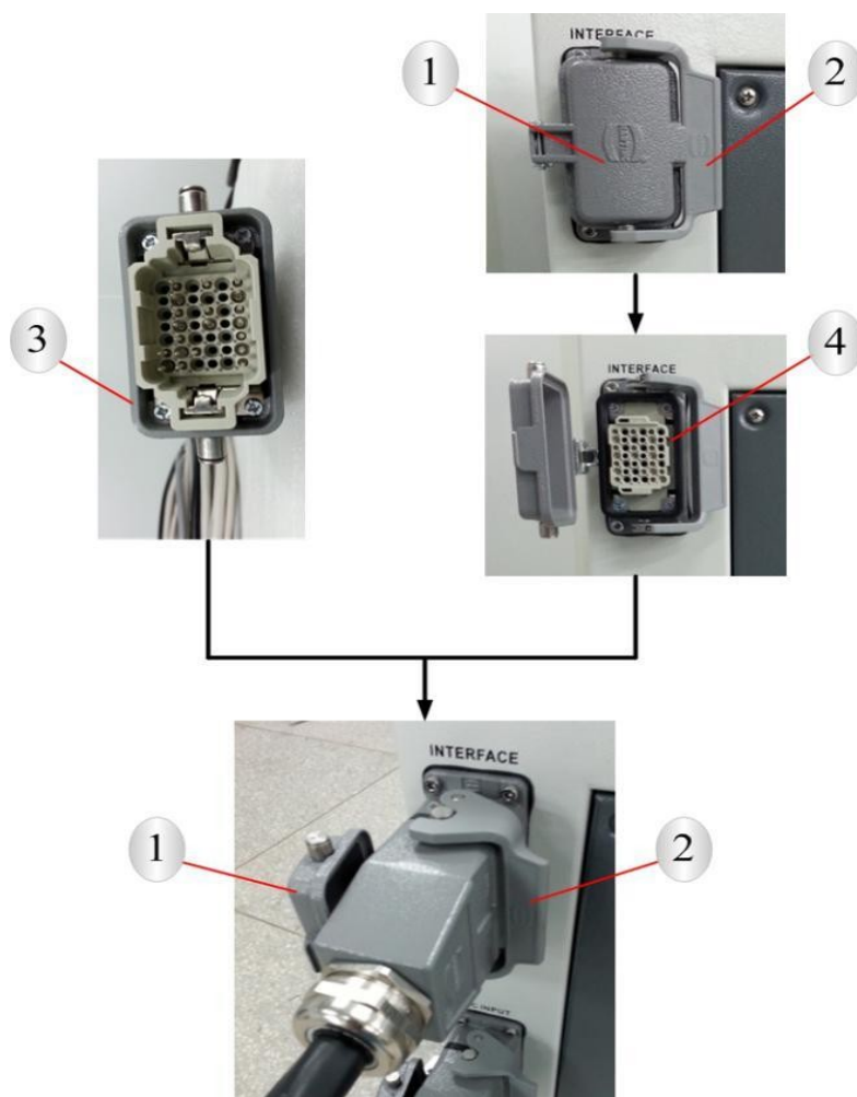
Рисунок 3 — Подключение кабеля к разъёму INTERFACE
