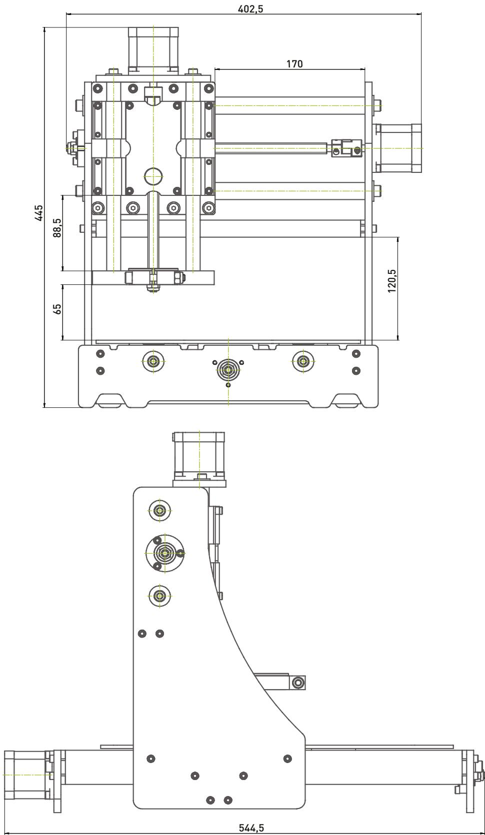
Рис. 1. Габаритные размеры.
