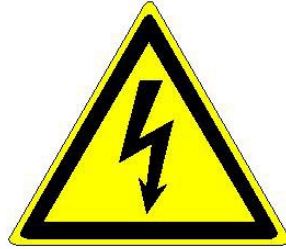
Рис. 4. Опасность поражения электрическим током.
