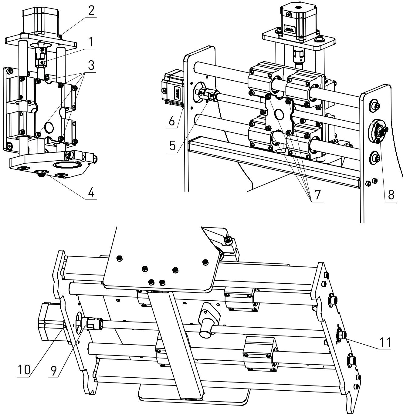
Рис. 8. Общая схема узлов станка.
