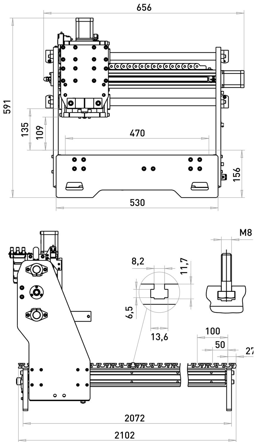
Рис. 8. Общая схема узлов станка.
