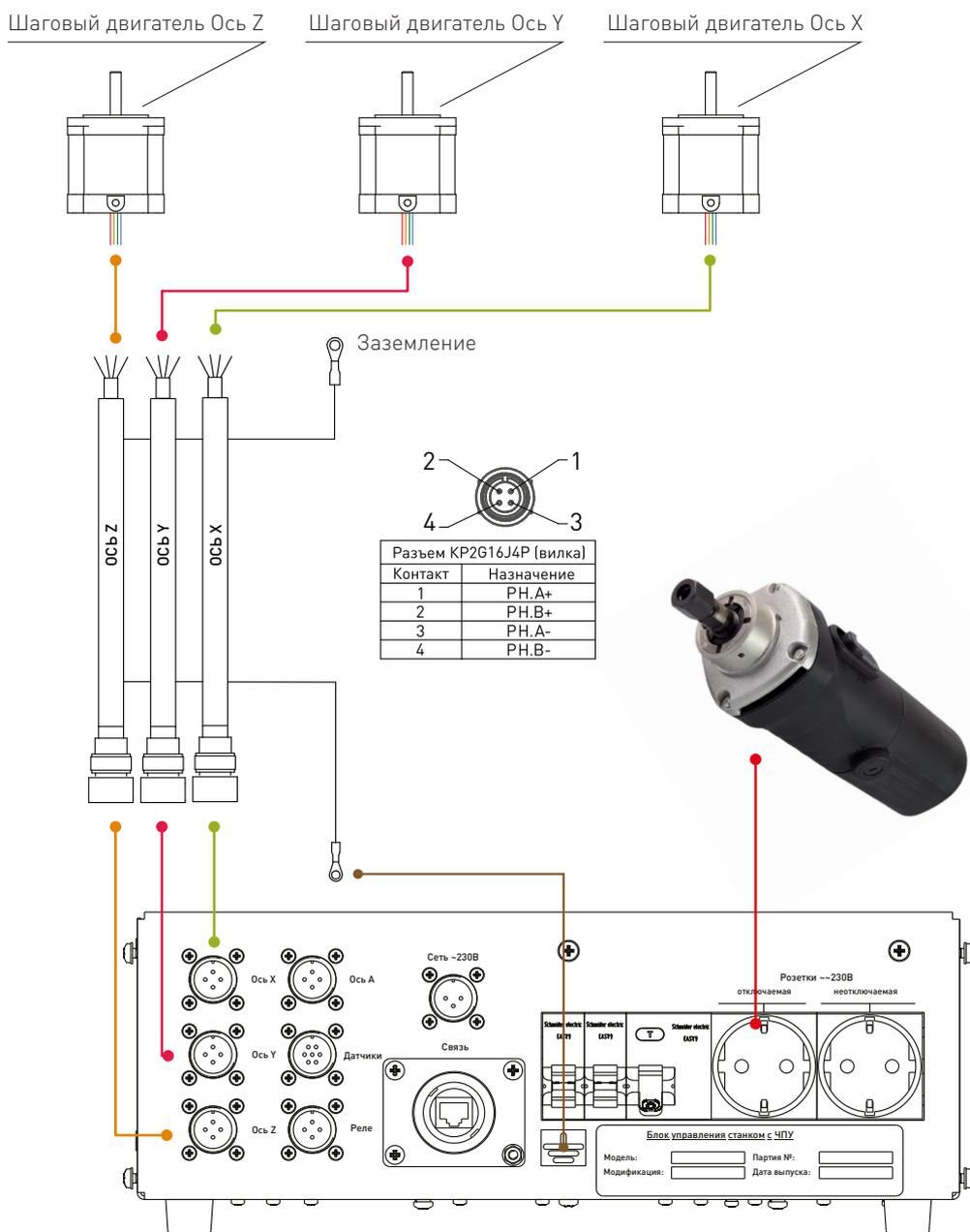
Рис. 6. Схема подключения PLRA3-L18 к блоку управления станком с ЧПУ CNC57L.
