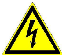
Рисунок 8 — Опасность поражения электрическим током.
