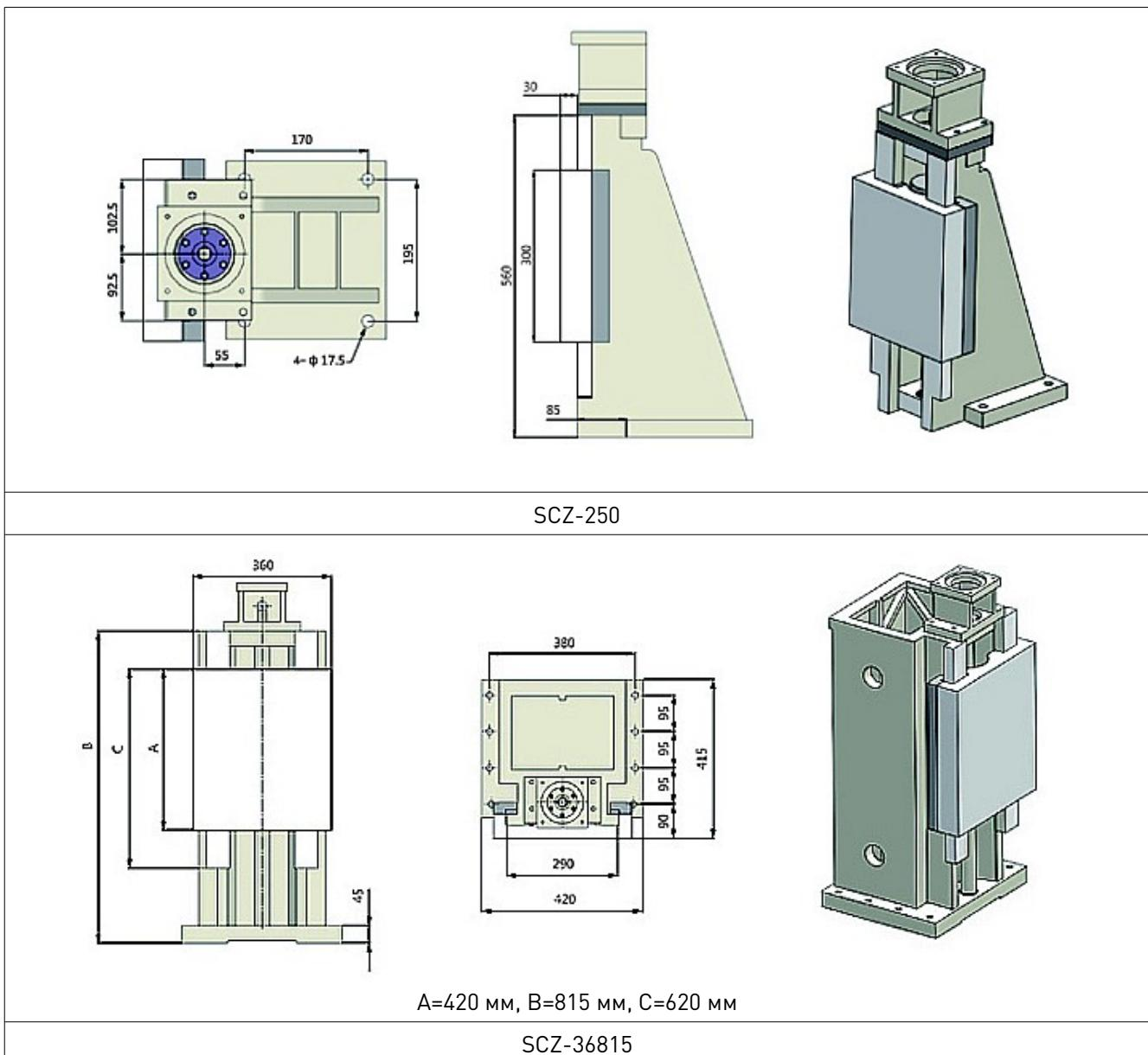
Рис. 2. Габаритные и установочные размеры модулей линейного перемещения (мм)
