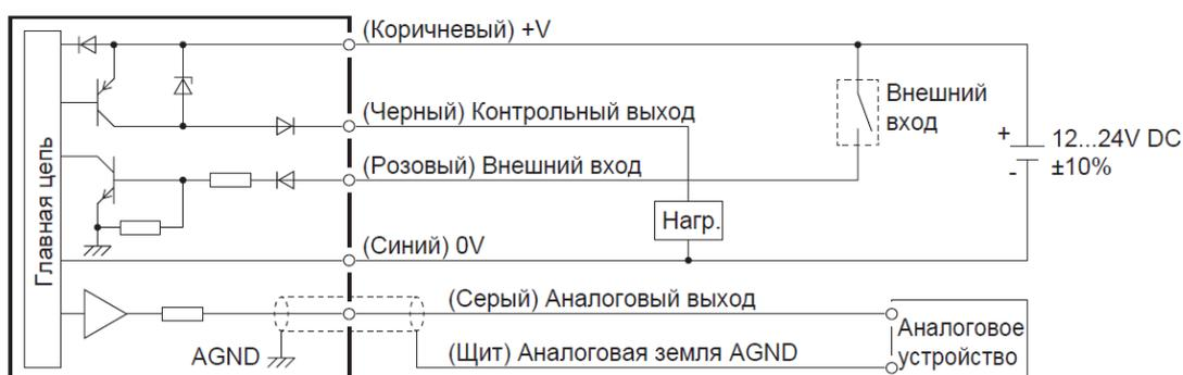
Рисунок 9 - подключение датчика по схеме PNP.
