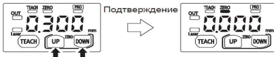
Рисунок 21 — Алгоритм действий при установке нуля.
