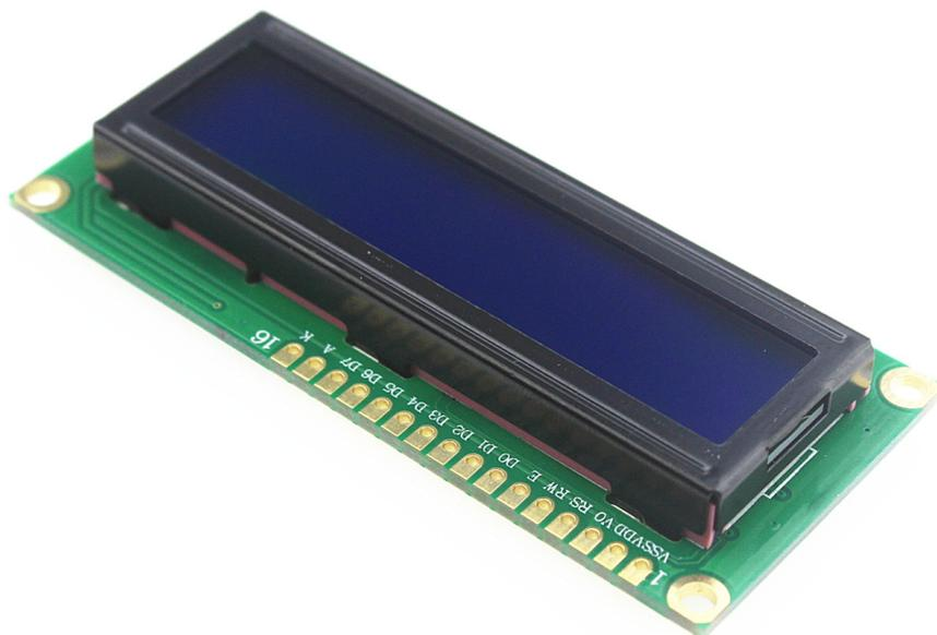
**Символьный (буквенно-цифровой) LCD дисплей.** 2 строки по 16 символов. Построен на базе контроллера HD44780. По умолчанию поддерживается в Arduino IDE с помощью библиотеки LiquidCrystal.
