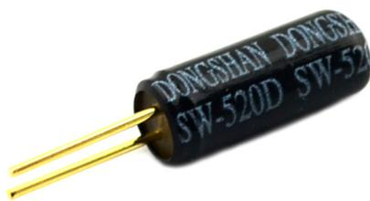
Датчик вибрации/наклона SW-520 (2 шт.)
