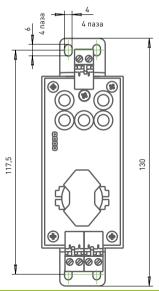
Рис. 1. Габаритные размеры модуля PLZ024
