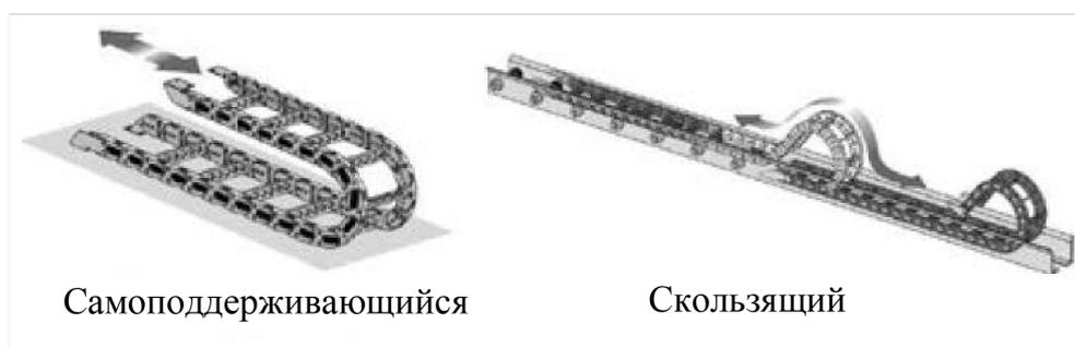
7. Для скользящей кабельной цепи рекомендуется зафиксировать кабель в подвижной точке. В месте крепления требуется предусмотреть небольшую защитную зону кабеля. (См. инструкции поставщика кабельной цепи)
