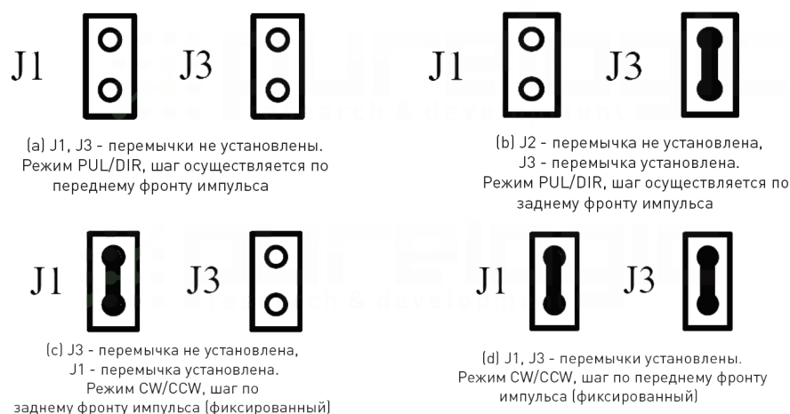
Рис. 2. Перемычка J1 и J3
