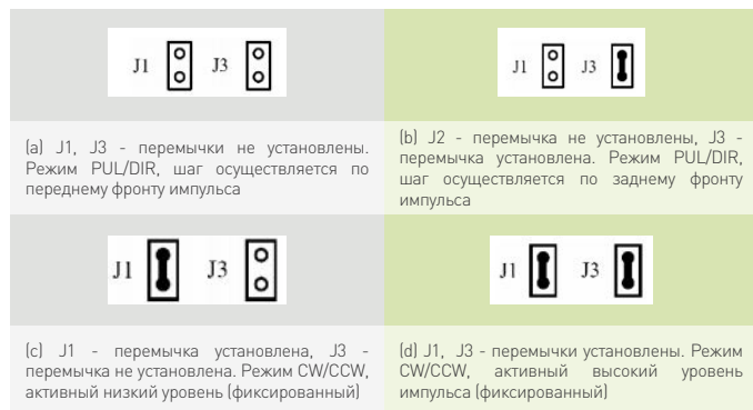
Рис. 2. Перемычка J1 и J3
