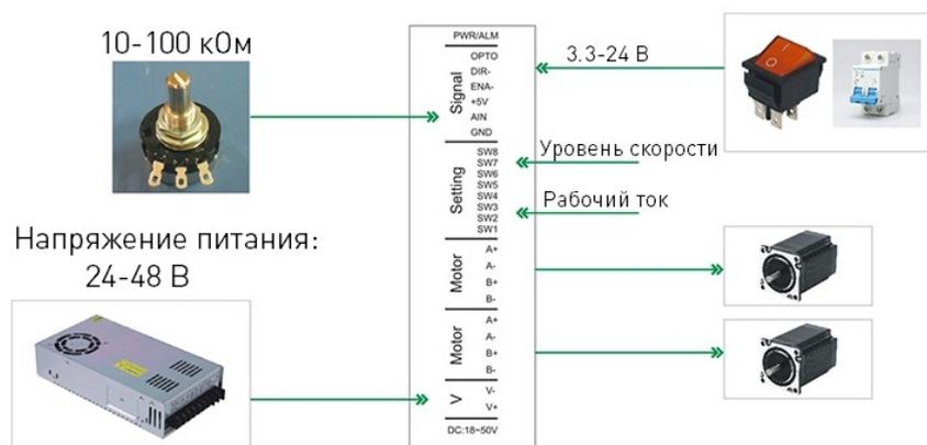
Рис. 3. Подключение драйвера HD57-2A
