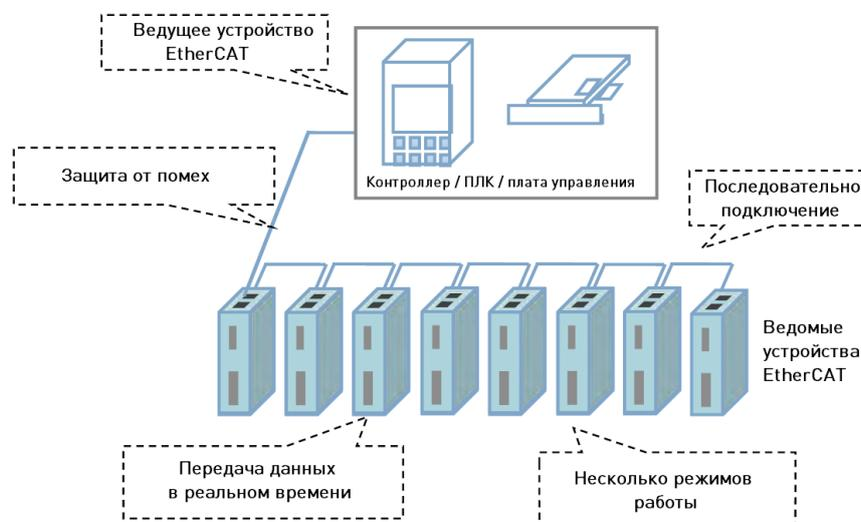
Рис. 2. Топология подключения по протоколу управления EtherCAT
