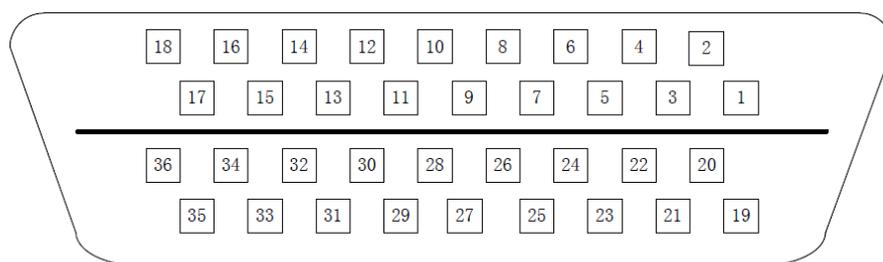
图 4.1 面对接口 CN1 36芯插头焊片看
