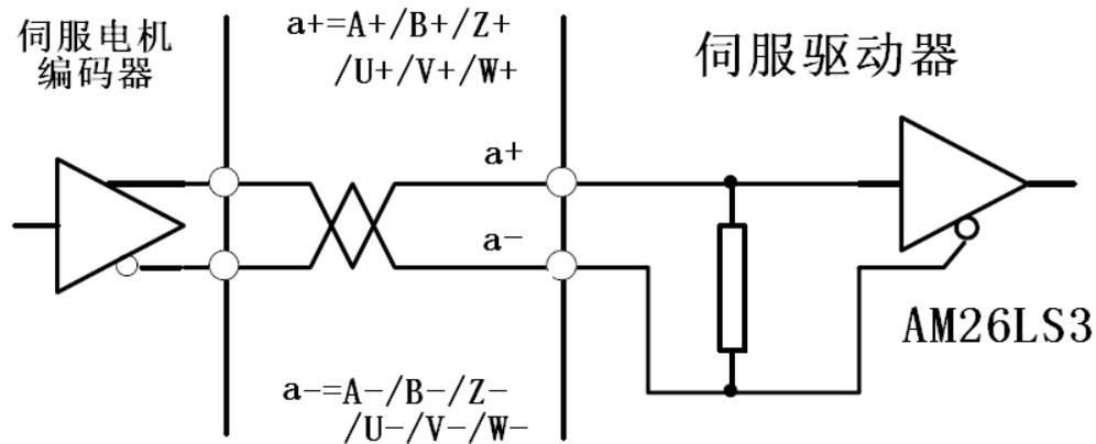
图 4.7 CN2 光电编码器输入接口
