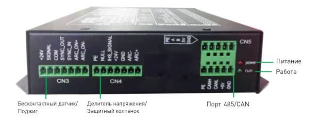
Рисунок 10 – Задняя панель основного блока контроллеров ТНС F1627D, F1628D.
