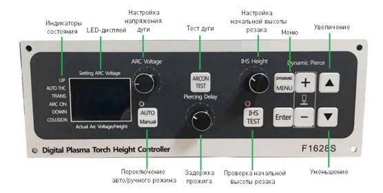
Рисунок 13 – Панель оператора F1628S (расположение элементов панели оператора контроллера F1628D, а также передней панели контроллера F1629DV аналогично).
