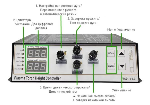
Рисунок 7 – Передняя панель контроллера ТНС F1621.
