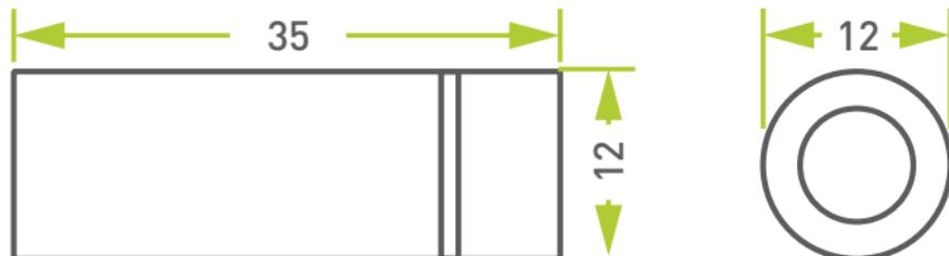
Рис. 1. Размеры устройств серии LDM650
