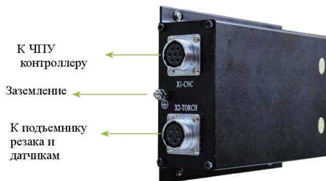
Рис.4. Подключение СНС-400
