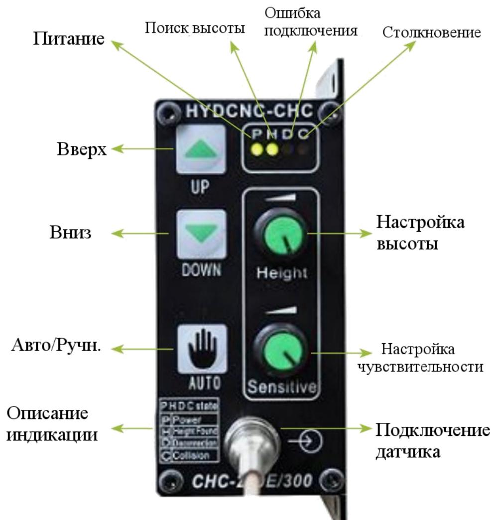
Рис.3. Панель оператора CHC-400
