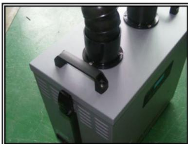
Отрегулируйте положение воздухопровода, установите сопло вблизи области задымления.
