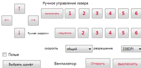
Клавиши со стрелками предназначены для ручного позиционирования лазерной головки.
