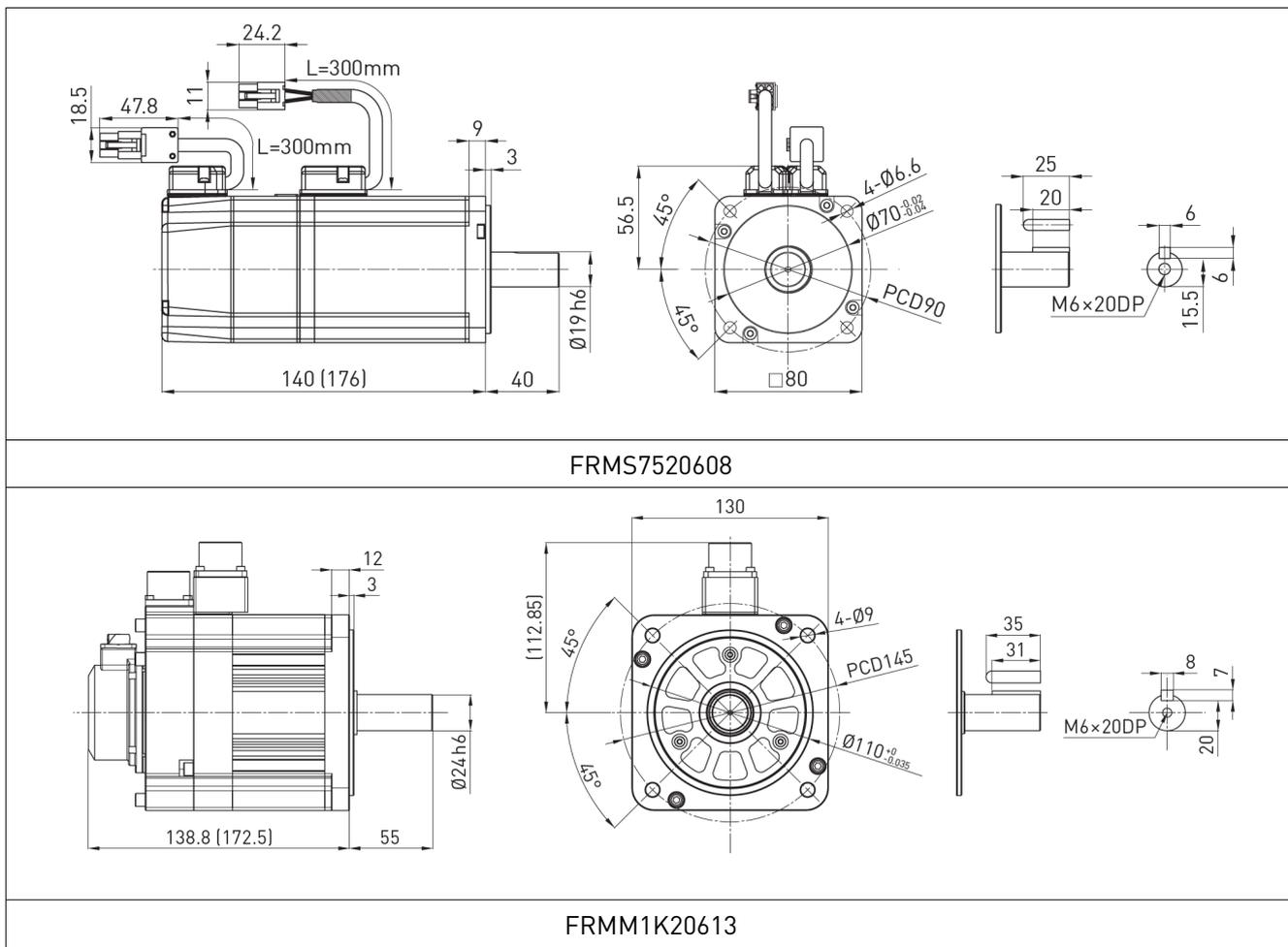
Рис. 2. Габаритные и установочные размеры двигателей
