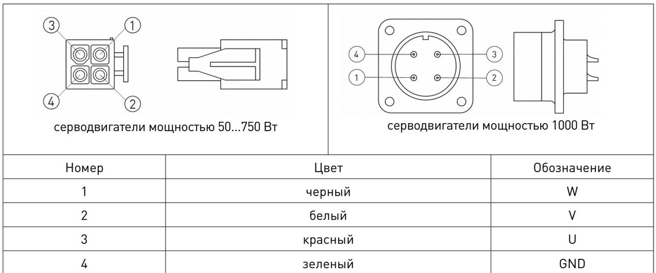
Рис. 3. Разъемы серводвигателей
