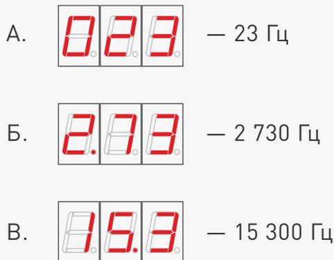
Рис. 3. Индикация частоты сигнала STEP
