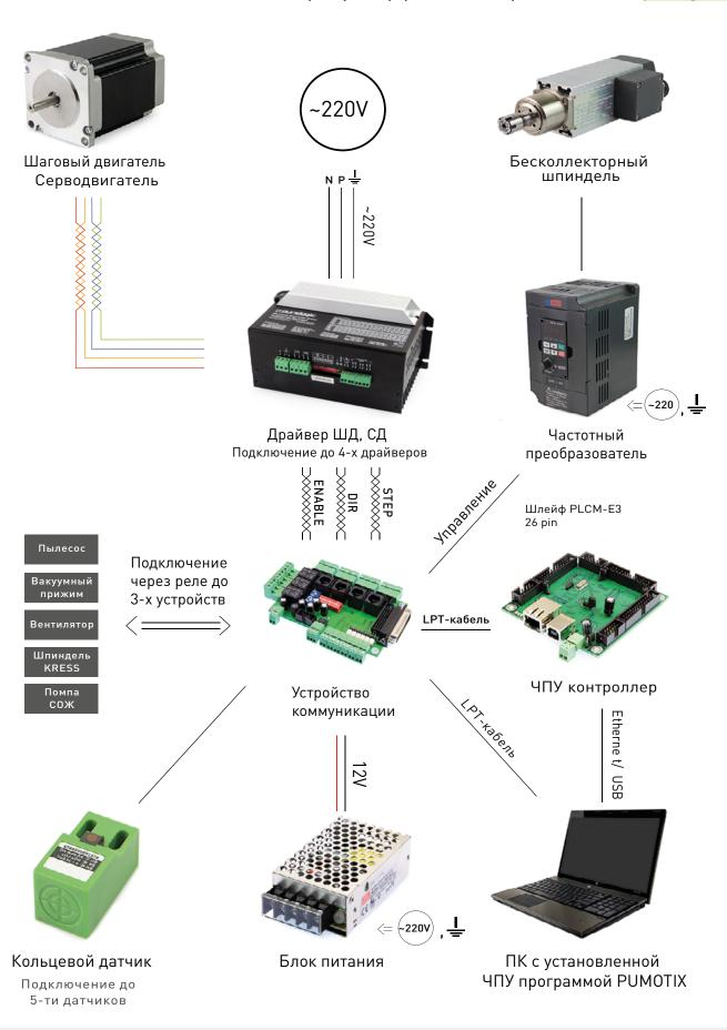
Рисунок 4 — Общая схема системы управления станком ЧПУ
