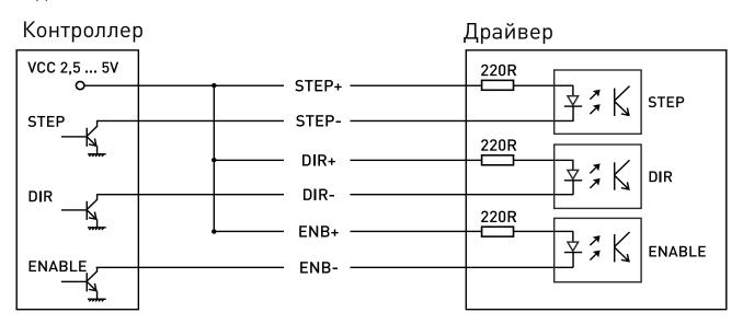
Рисунок 3 — Устройство дифференциальных входов
