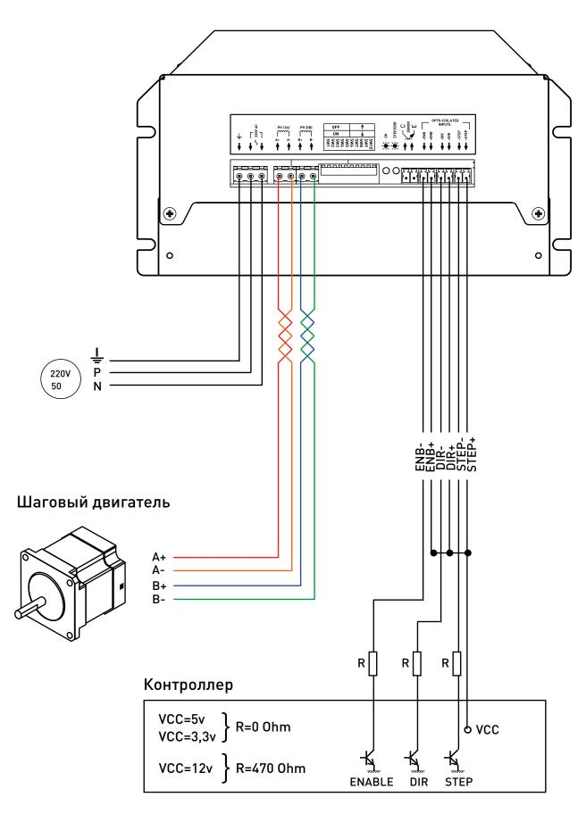
Рисунок 5 — Общая схема подключения драйвера
