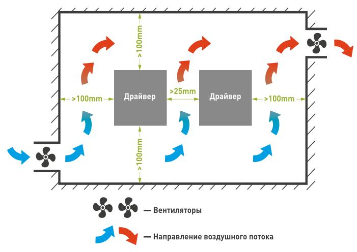
Рисунок 2 — Схема установки драйвера PLD8220-G2.
