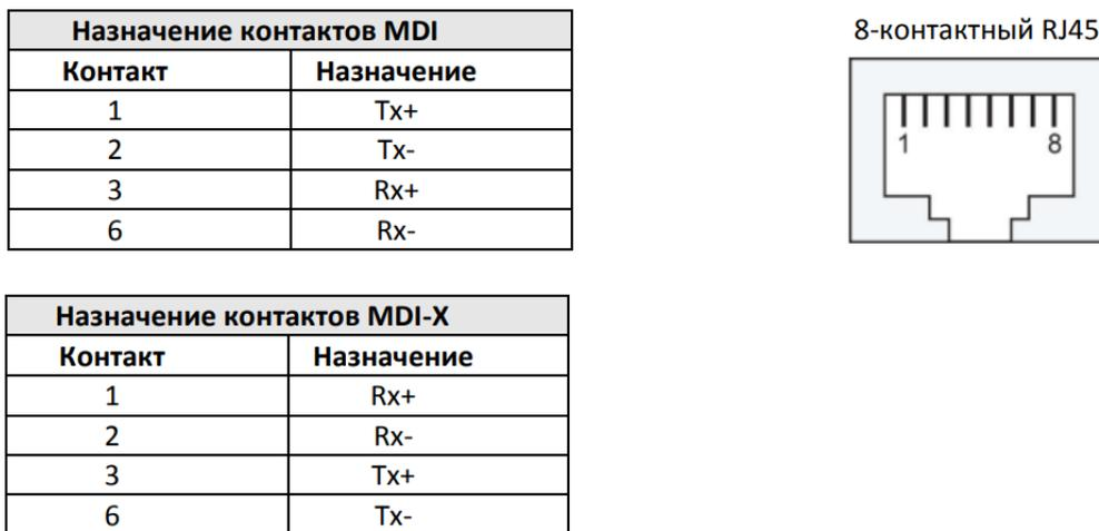
Рис. 7. Назначение контактов и распиновка разъема RJ45
