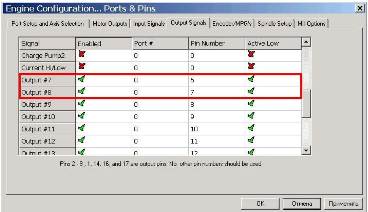
Меня мышкой состояние Active Low для настроенного Output #1 ... Output #8, можно убедиться в работоспособности настроенного устройства.
