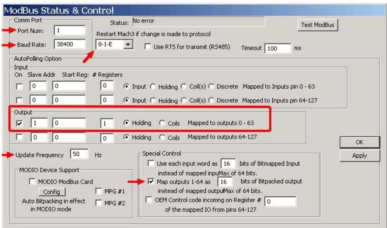
Теперь необходимо соотнести выходные сигналы программы MACH3 и реле K1...K8 на плате **PLA001mb**. Порт MODBUS в программе MACH3 – это “0” порт. Реле “K1” это “Pin #7” ... Реле “K8” это “Pin #0”.
