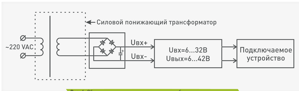
Рис. 4. Общая схема подключения модуля преобразователя напряжения
