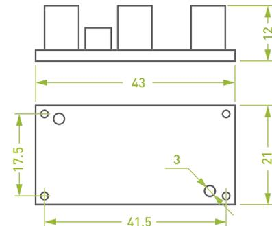
Рис. 1. Размеры модуля SU3235-02-1
