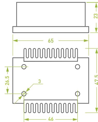
Рис. 2. Размеры модуля SU3235-10-1
