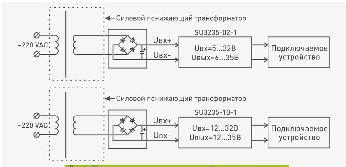
Рис. 4. Общая схема подключения модуля преобразователя напряжения
