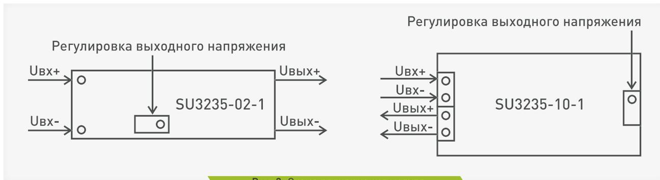
Рис. 3. Схема подключения модуля
