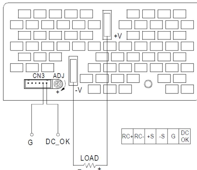
Рис. 6. Подключение сигнала DC\_OK
