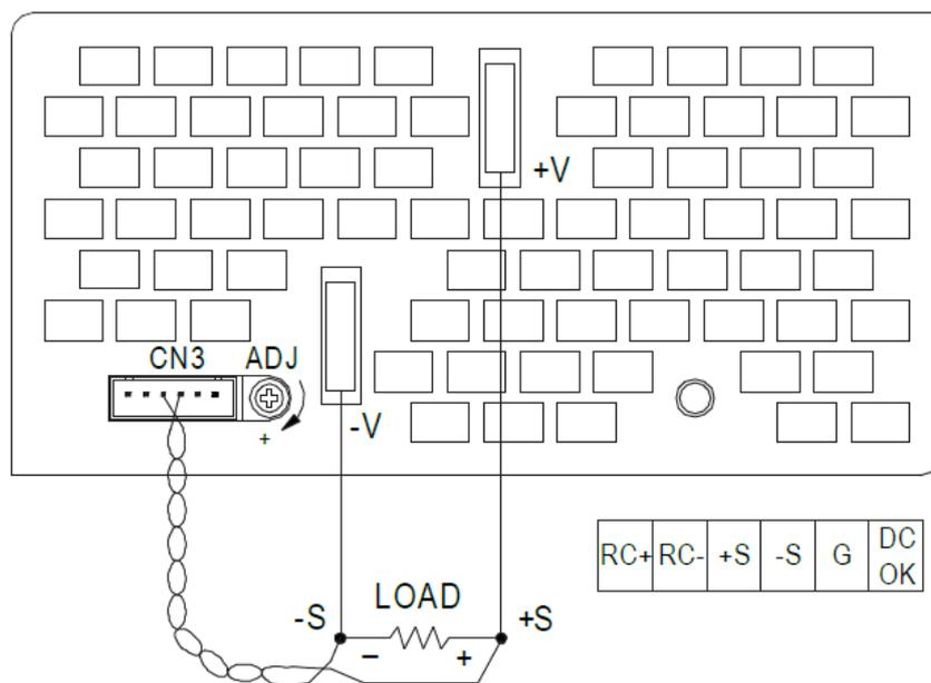
Рис. 8. Подключение внешнего датчика
