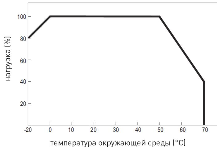
Рис. 4. Зависимость нагрузки от температуры окружающей среды
