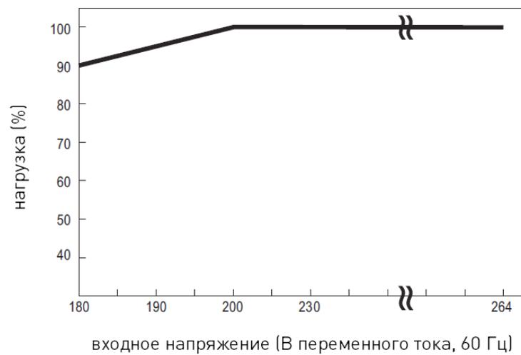
Рис. 5. Зависимость нагрузки от входного напряжения
