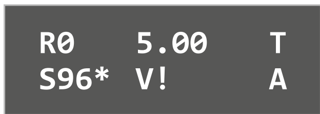
Рисунок 24 — Индикация при OVERVOLTAGE.
