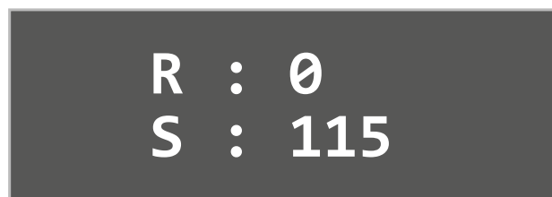
Рисунок 21 — Реальное (R) и желаемое (S) напряжение дуги.
