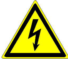
Рис. 5. Опасность поражения электрическим током
