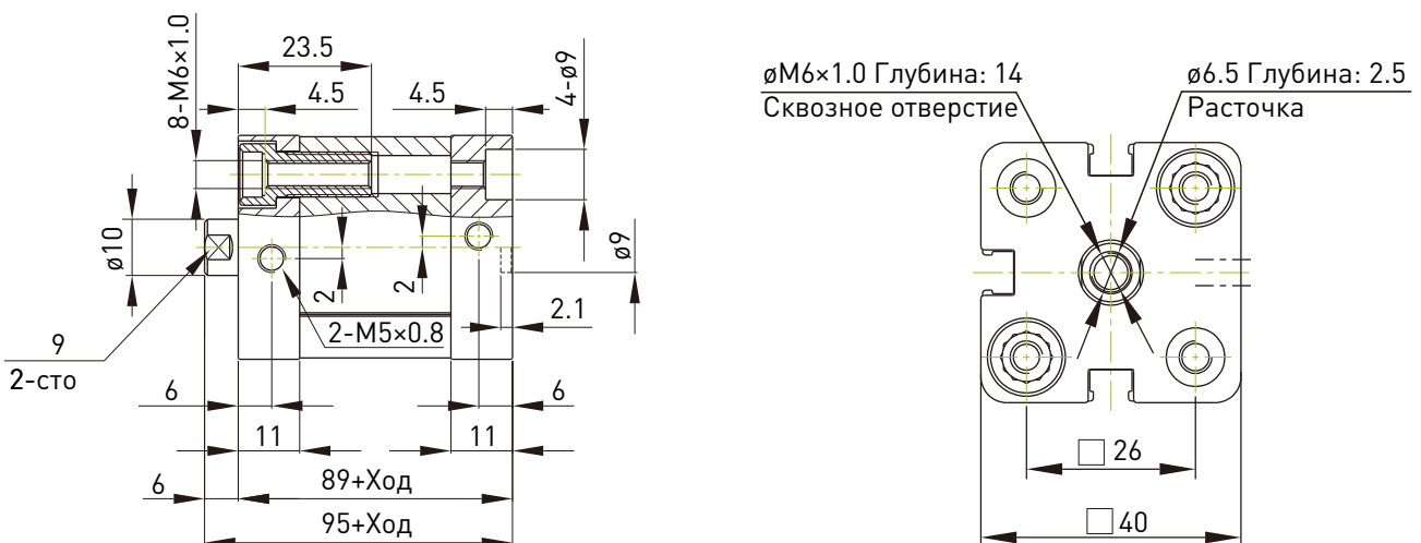
Габаритные и присоединительные размеры ACE25*50
