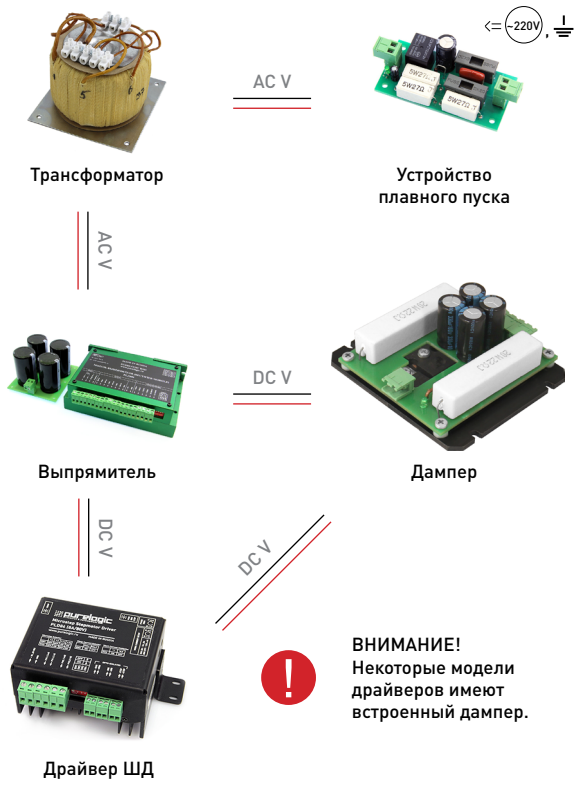
Рис. 2. Обобщенная схема построения силовой части станка
