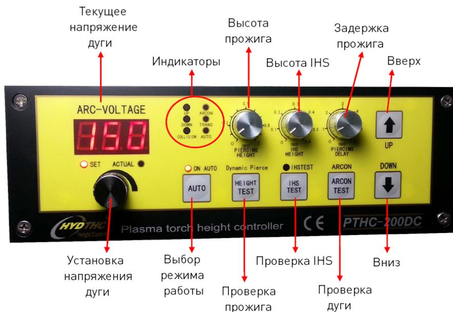
Рис. 3. Панель управления РТНС-200DC
