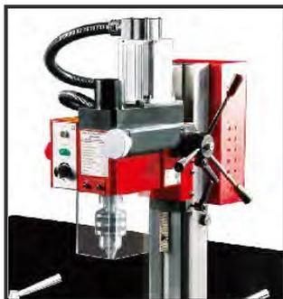
Модель SM6Lux доступна с 500Вт бесщеточным двигателем сверлильной головы
