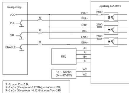
Рис. 10. Типовая схема подключения
