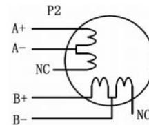
Рис. 6. Подключение двигателя с 6 выводами (полуобмотка, высокая скорость)
