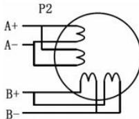
Рис. 9. Схема параллельного подключения двигателя с 8 выводами
