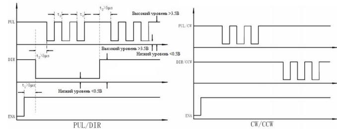
Рис. 11. Схема последовательности управляющих сигналов
