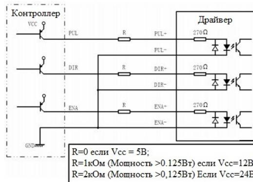
Рис. 4. Подключение к выходам PNP (с общим катодом)
