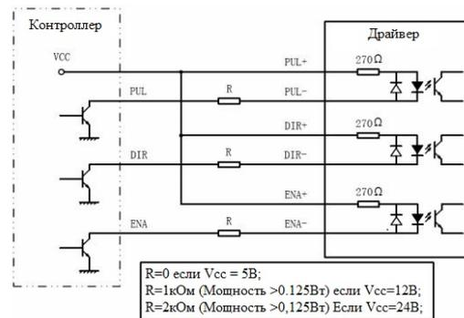
Рис. 3. Подключение к выходам "открытый коллектор" (с общим анодом)
