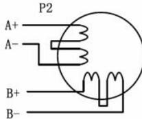
Рис. 8. Схема последовательного подключения двигателя с 8 выводами
