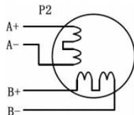
Рис. 5. Схема подключения двигателя с 4 выводами
