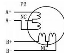
Рис. 6. Подключение двигателя с 6 выводами (полная обмотка, высокий момент)
