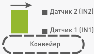
Рис. 5. Схема расположения датчиков сортировки по высоте
