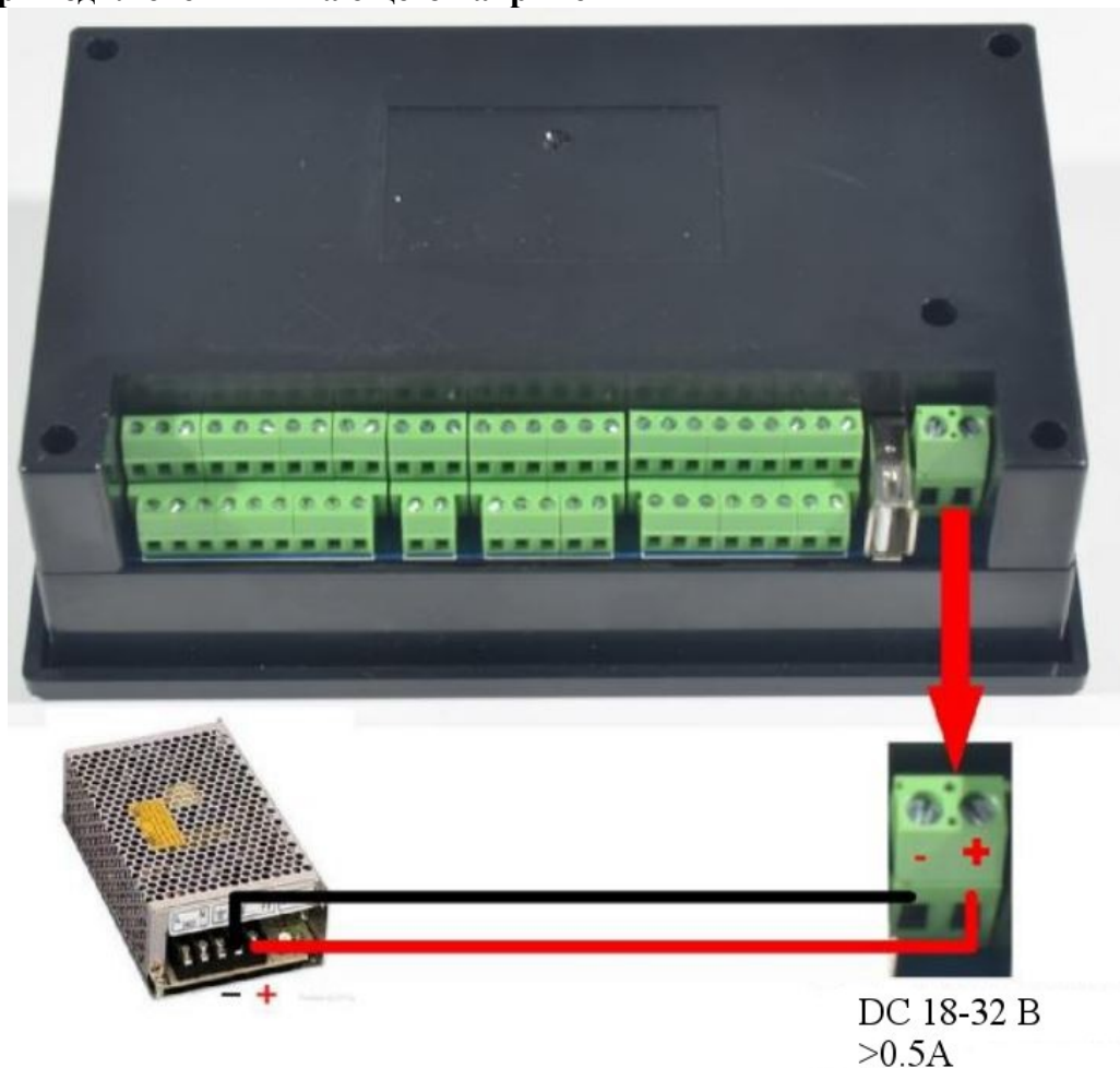
Рисунок 2-3. Схема подключения напряжения питания
