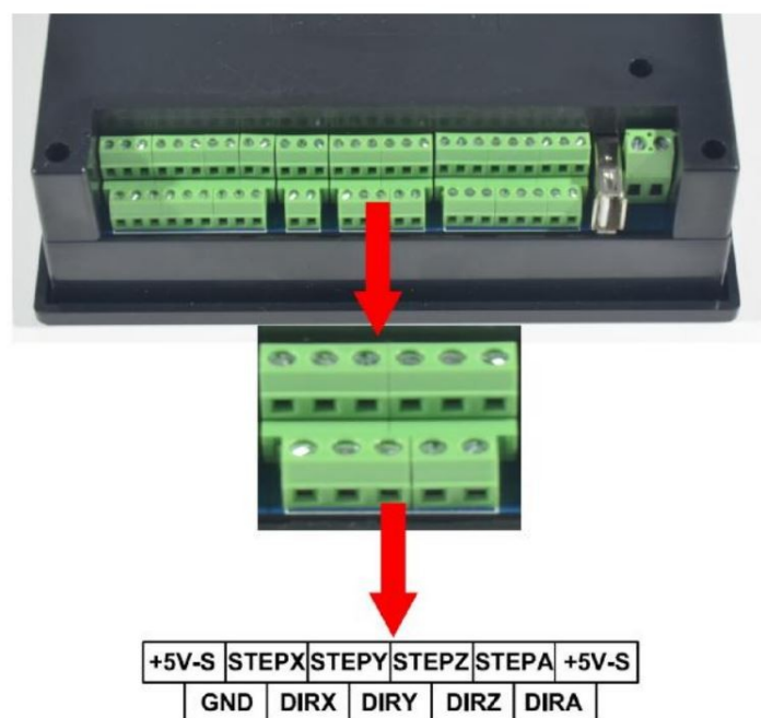
Рисунок 2-7. Интерфейс подключения двигателей
