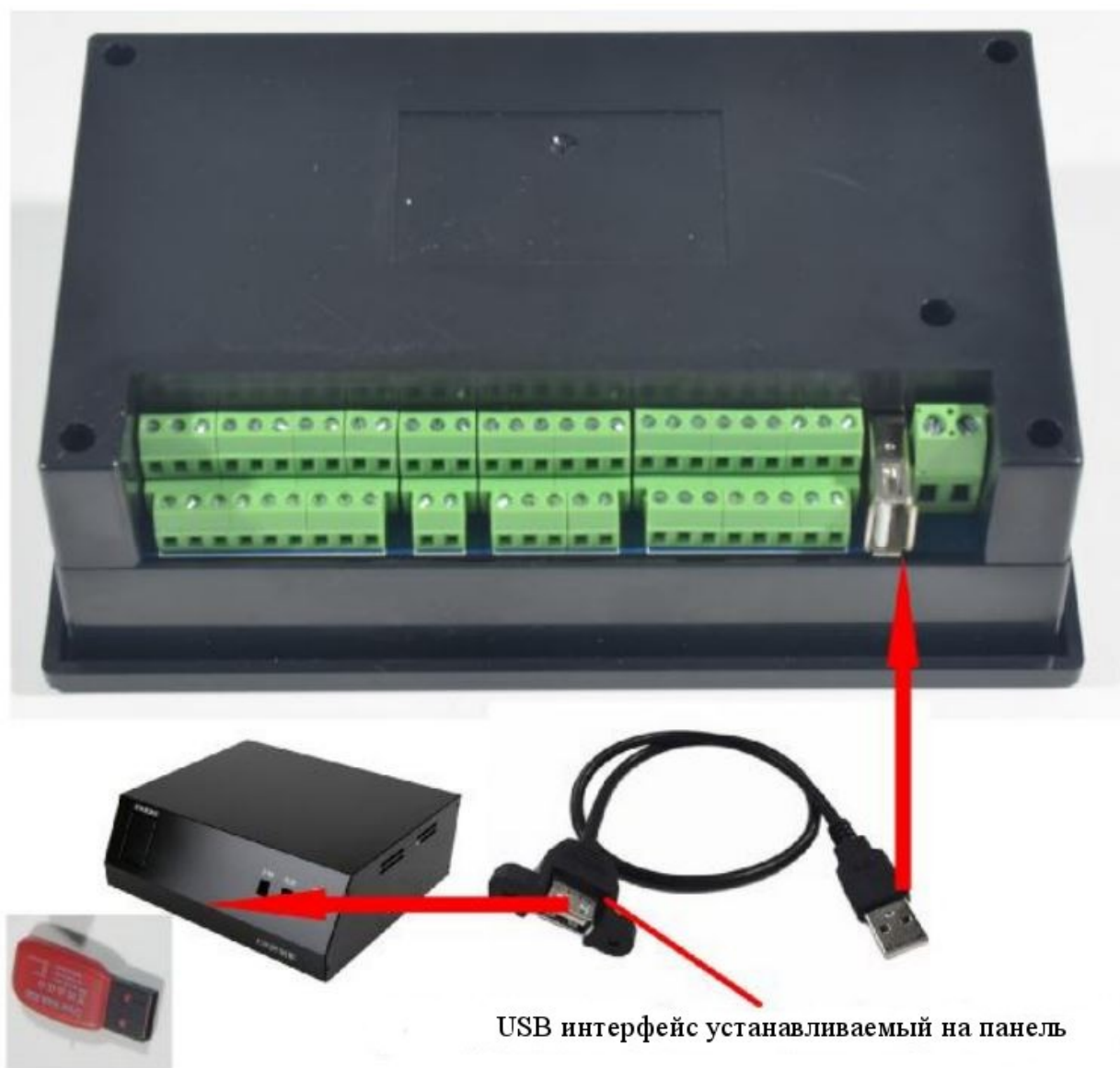
Рисунок 2-4 Схема подключения USB интерфейса
