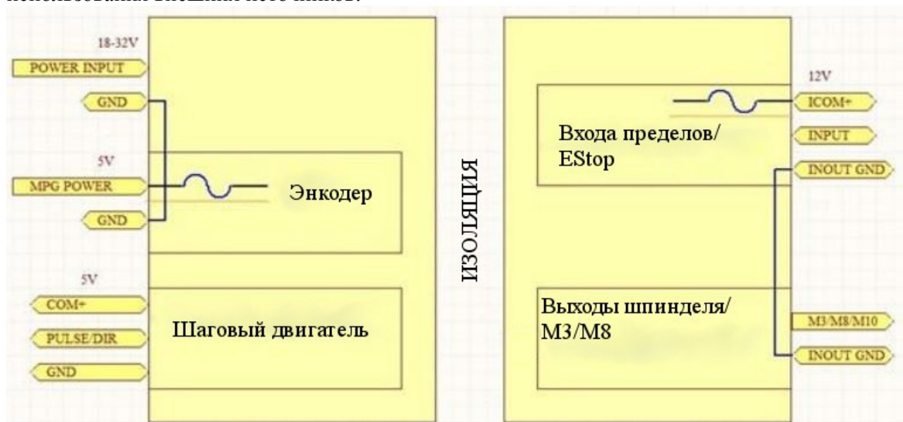
Рисунок 2-1. Подключение источников питания
