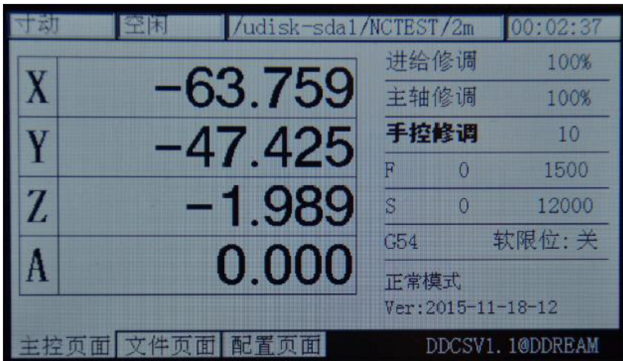
Рисунок 3-35. Применение SJR с установленным значением, равным 10
