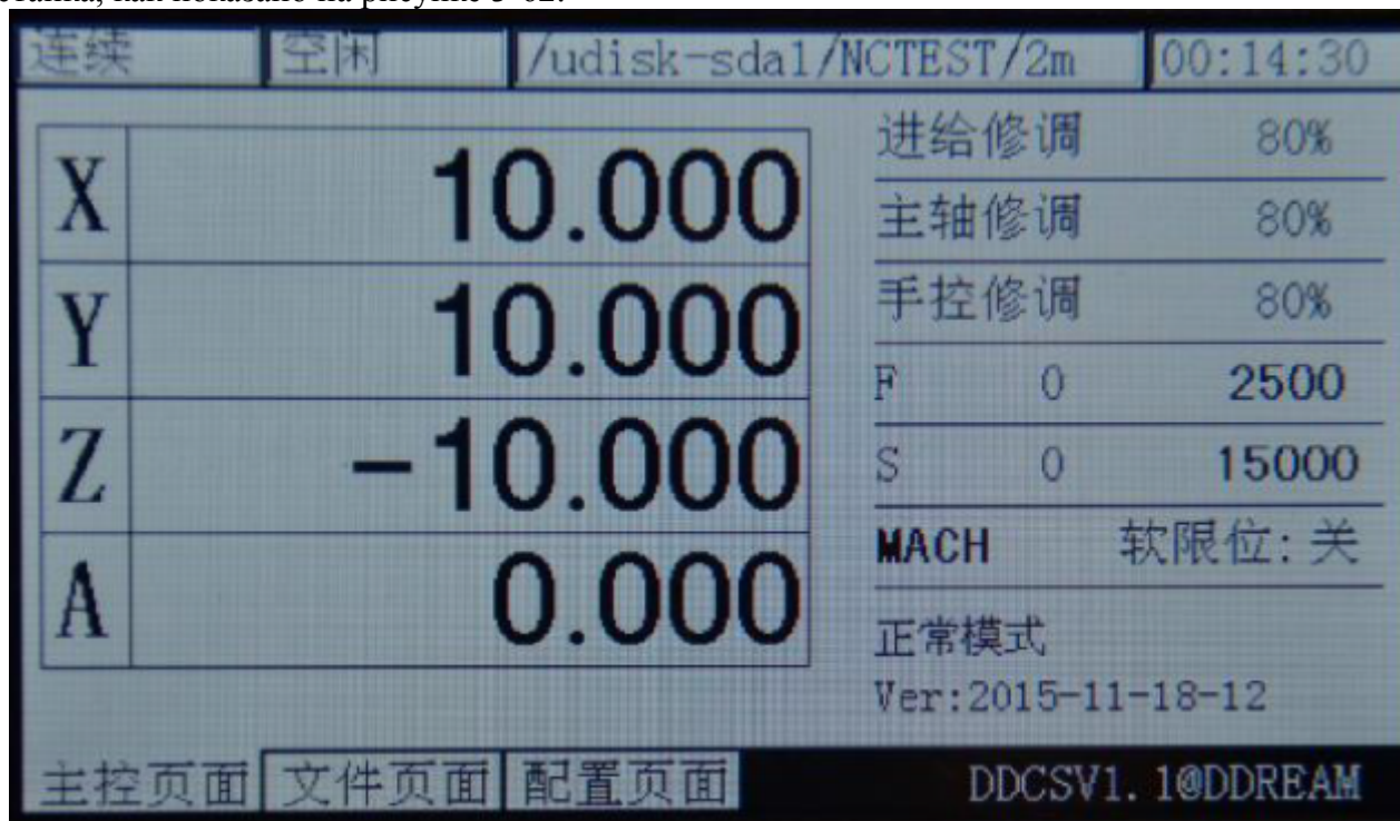
Рисунок 3-62. Переключение на систему координат станка
