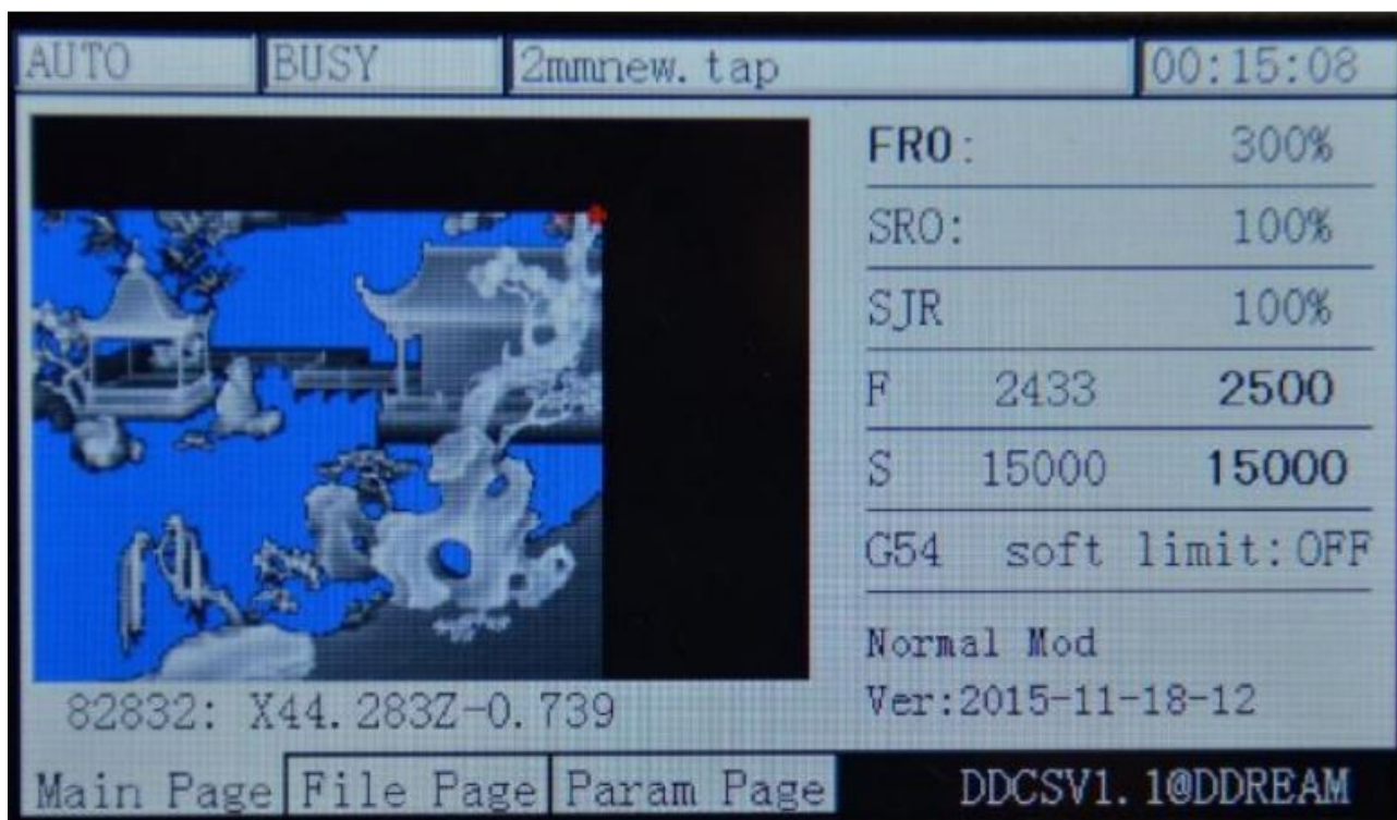
Рисунок 3-15. Состояние управляющей траектории при приближении к завершению процесса
